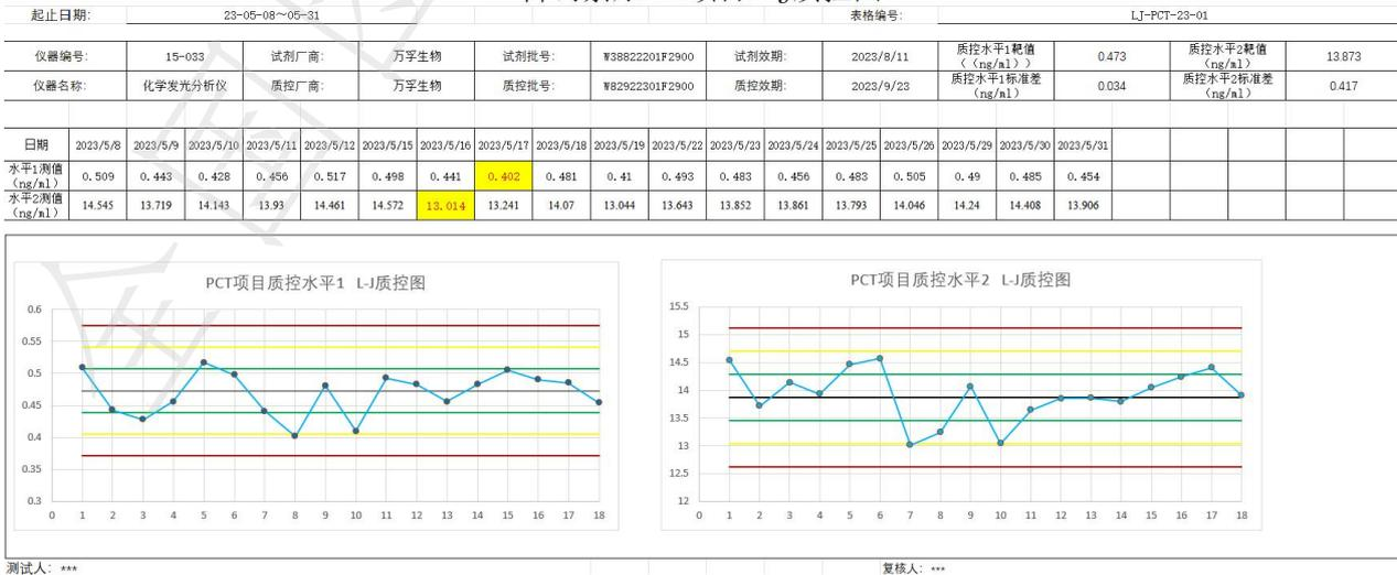
图 B.1 PCT 项目 L-J 质控图绘制
